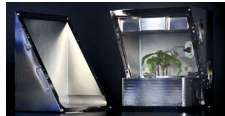
Om bord på den internasjonale romstasjonen skal det dyrkes mungbønner for å finne ut hvordan plantene reagerer på forskjellig tyngdekraft og hvordan vannet beveger seg i verdensrommet. Minidrivhusene er utviklet av en gruppe ingeniører og forskere under ledelse av Liz Coelho ved CIRiS i Trondheim. Foto: Liz Coelho, CIRiS, NTNU Samfunnsforskning AS
